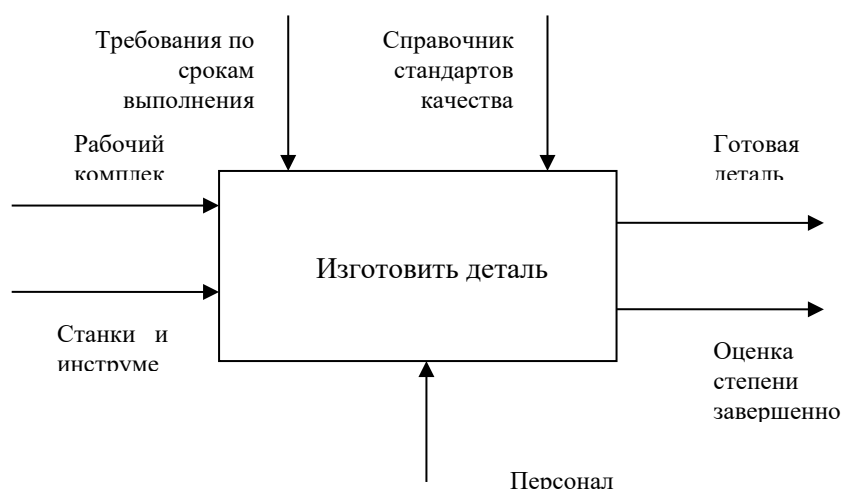
Рисунок1. Контекстная диаграмма А-0 системы «Экспериментальный цех механообработки». Функция (цель) системы – Изготовить деталь.
