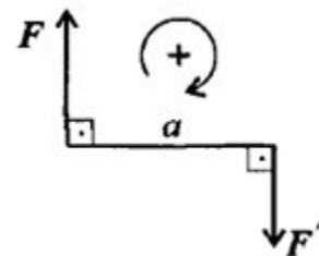
**13. «Силу можно перенести параллельно линии ее действия силы, при этом нужно добавить пару сил с моментом, равным произведению модуля силы на расстоянии, на которое перенесен сила». Речь идет о**
