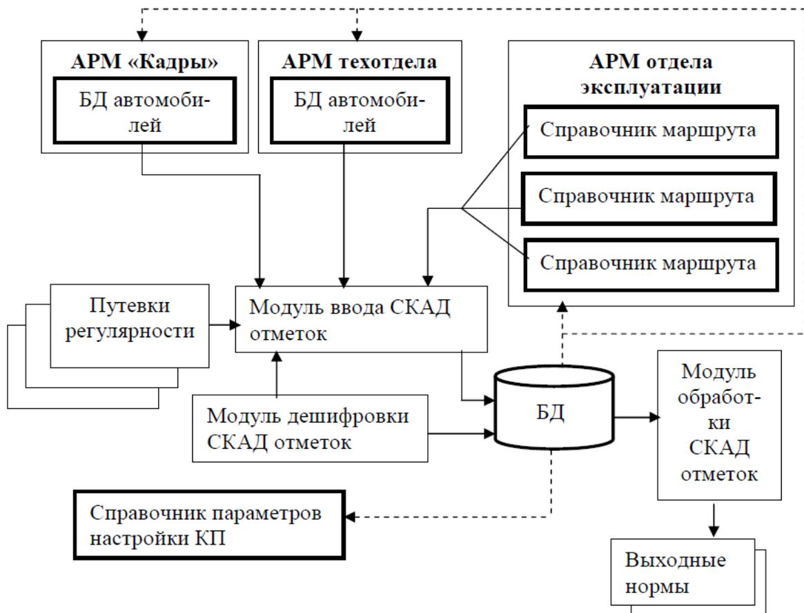
Рисунок 7 - Функциональная схема АРМ обработки СКАД отметок
