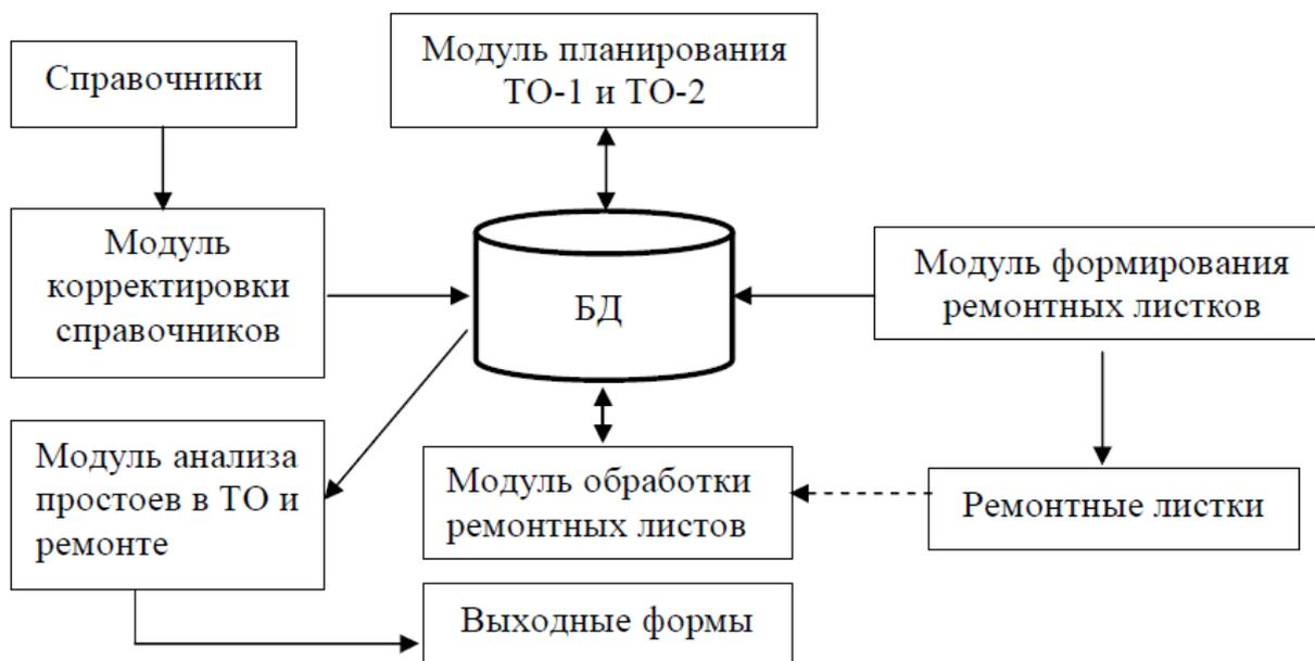
Рисунок 12 - Функциональная схема АРМ ремонтной службы
