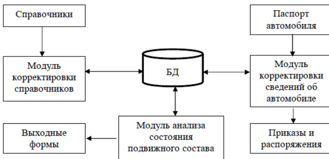
Рисунок 4 - Функциональная схема АРМ технического отдела
