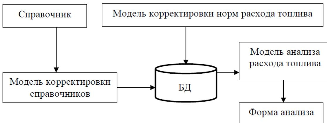
Рисунок 10 - Функциональная схема АРМ техника по учёту топлива
