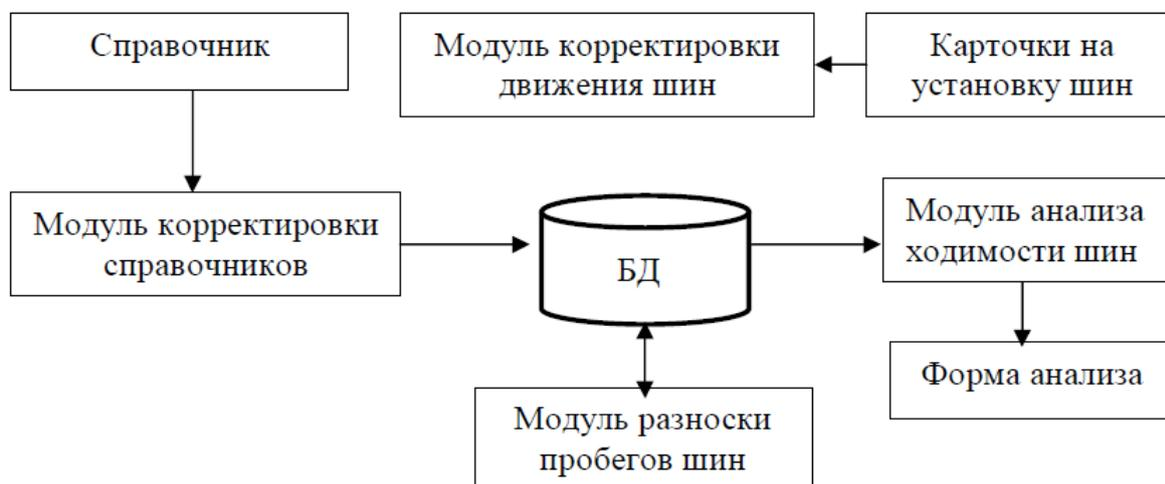
Рисунок 11 - Функциональная схема АРМ по учёту шин
