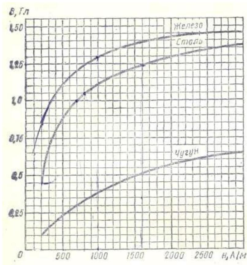
Связь между магнитной индукцией  $B$  поля в ферромагнетике и напряженностью  $H$  намагничивающего поля
