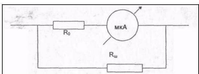
измерения силы тока до 10 мА? Схема подключения шунта приведена на рис. 7.
