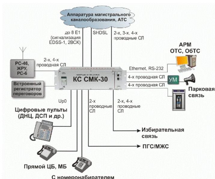
Рисунок 1.1 - Структурная схема аппаратно-программного комплекса связи на СМК-30
