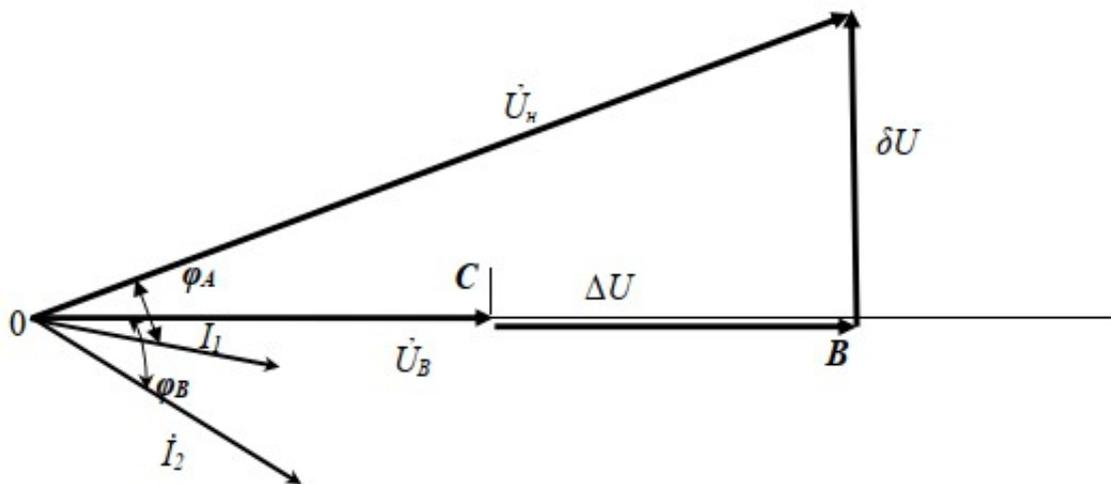
Рисунок - 1.2 Векторная диаграмма токов и напряжений
