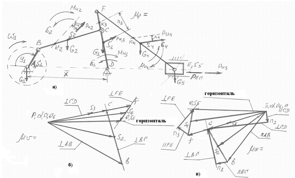
Рис. 1 Кинематическая схема механизма – а,
