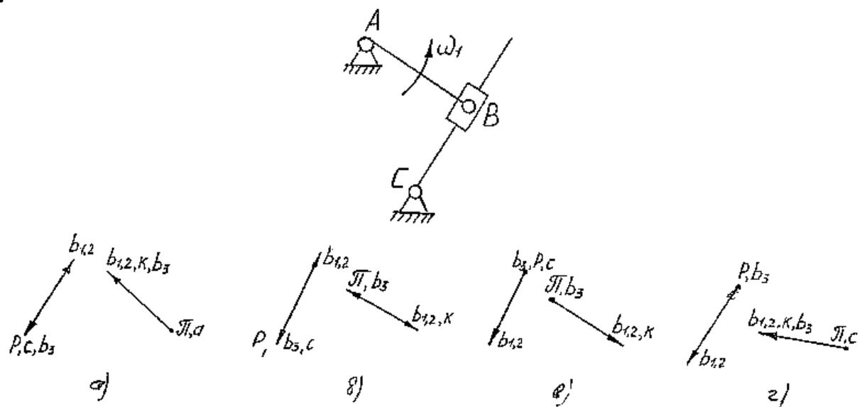
На каких схемах механизмов правильно указаны направления векторов инерционной нагрузки звеньев.
