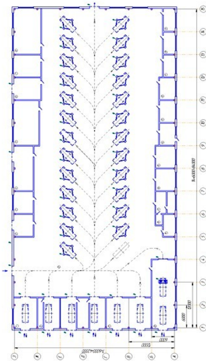
Рисунок П.1 – Производственный корпус для ТО и ТР на 361 легковой автомобиль ГАЗ-3102
